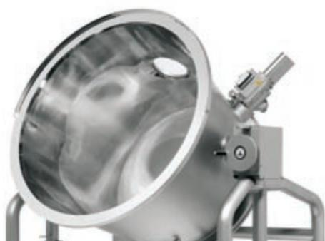
Контейнеры для продукта IMA оснащаются устройством распределения воздуха, выполненного в виде экрана, предотвращающего попадание продукта в нижнюю часть машины. Устройство распределения воздуха не приварено к контейнеру, оно может быть легко снято для проверки после чистки.
